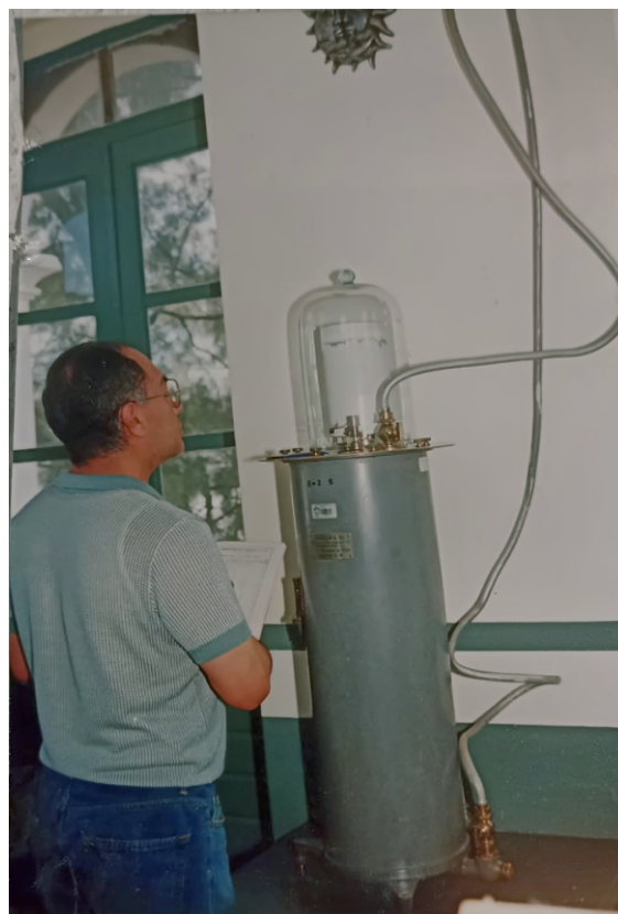
Fig. 3. Juan Pérez Domínguez (1995) Anemógrafo de Dines, de origen inglés, utilizado para medir y registrar la velocidad del viento. El instrumento consta de un sistema de tubos y veleta —sin puntos cardinales— que conduce el flujo de aire hacia el cuerpo del equipo, así como de un tanque con agua y un tambor accionado por un mecanismo de relojería para el registro continuo. Fotografía proporcionada por Ana Laura Pérez.
