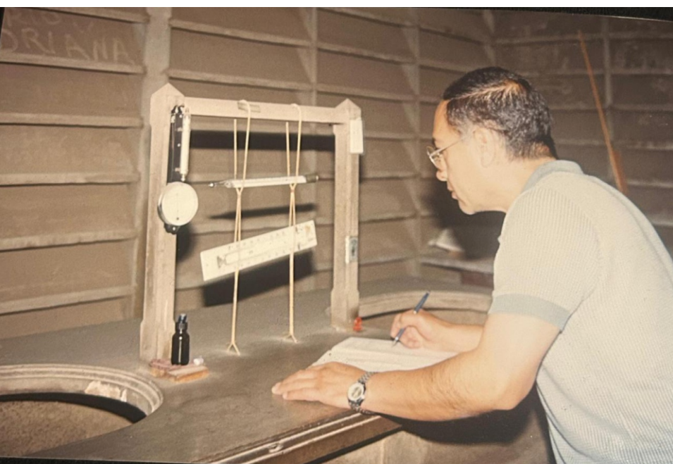
Fig. 1. Juan Pérez Domínguez (1995) en el "cuarto de abrigo" del segundo nivel del torreón del observatorio, espacio ventilado y protegido de la radiación solar directa por su estructura sin muros de concreto. El geógrafo realiza la medición de temperaturas extremas con termómetros Negretti de fabricación alemana —uno de mercurio para la máxima y otro de alcohol para la mínima—, cuyos registros constituyen las llamadas "temperaturas extremas". Fotografía proporcionada por Ana Laura Pérez.
